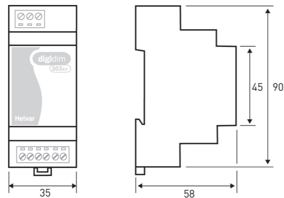
Корпус для монтажа на DIN-рейку: ширина на 2 модуля. Масса 80 г
